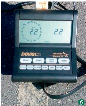
**РИСУНОК 10.3** – Вспомогательная аппаратура для работы с ветром – метеорологический комплекс Weather Wizard III производства Davis, определяющий направление и силу ветра. Используется в тренировочном процессе национальной сборной команды Российской Федерации по биатлону: а – флюгер; б – сам прибор
